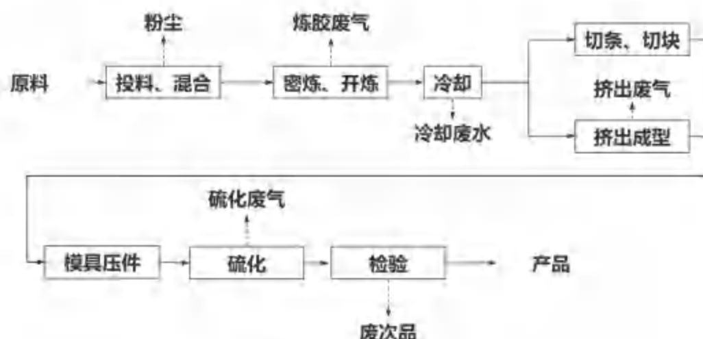
图 2-5 橡胶制品生产线流程及产污环节
