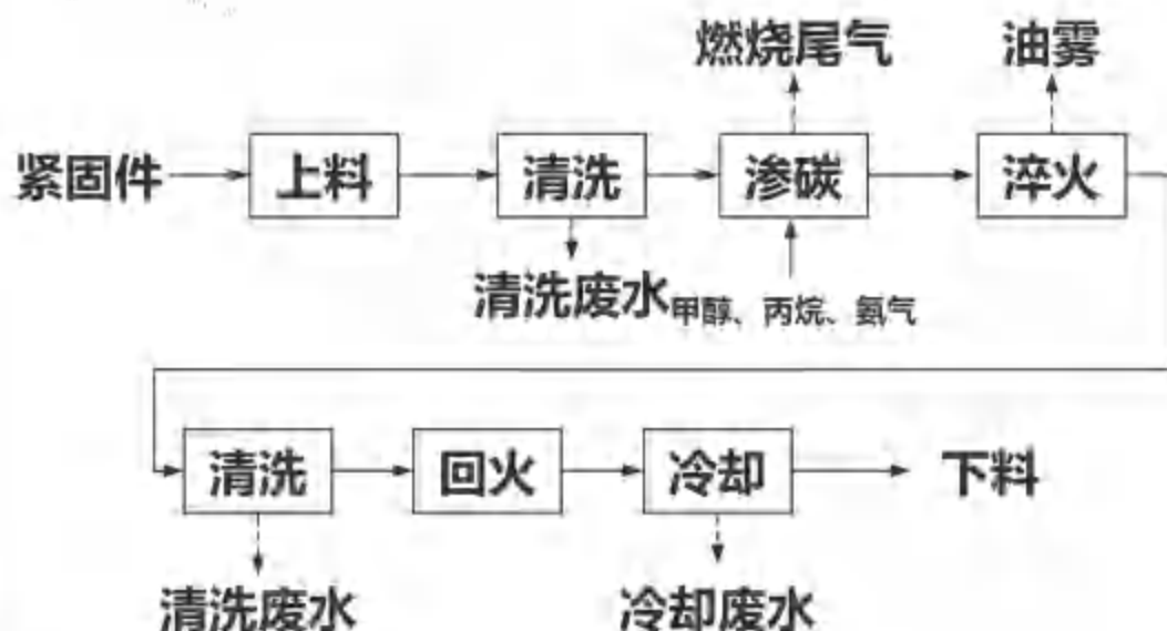
图 2-4 淬火热处理工艺流程
