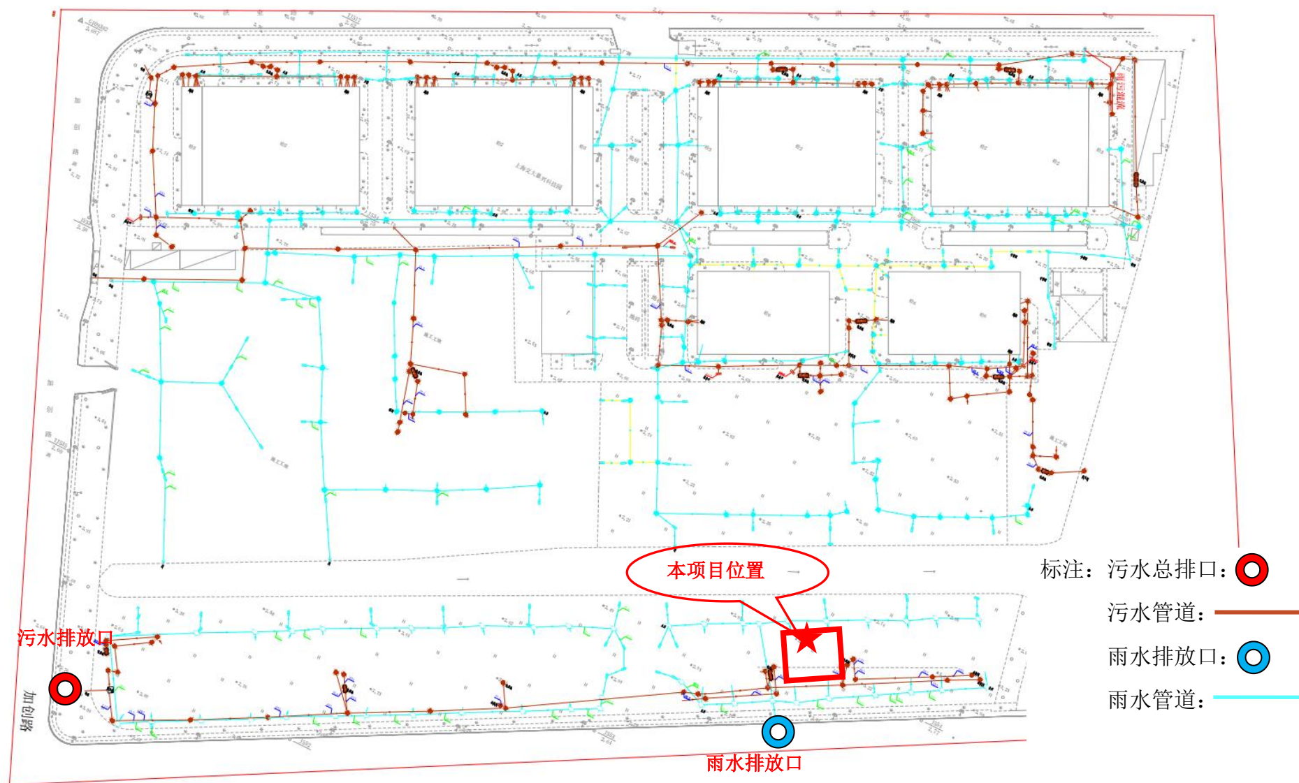
附图6 厂区雨污管网图
